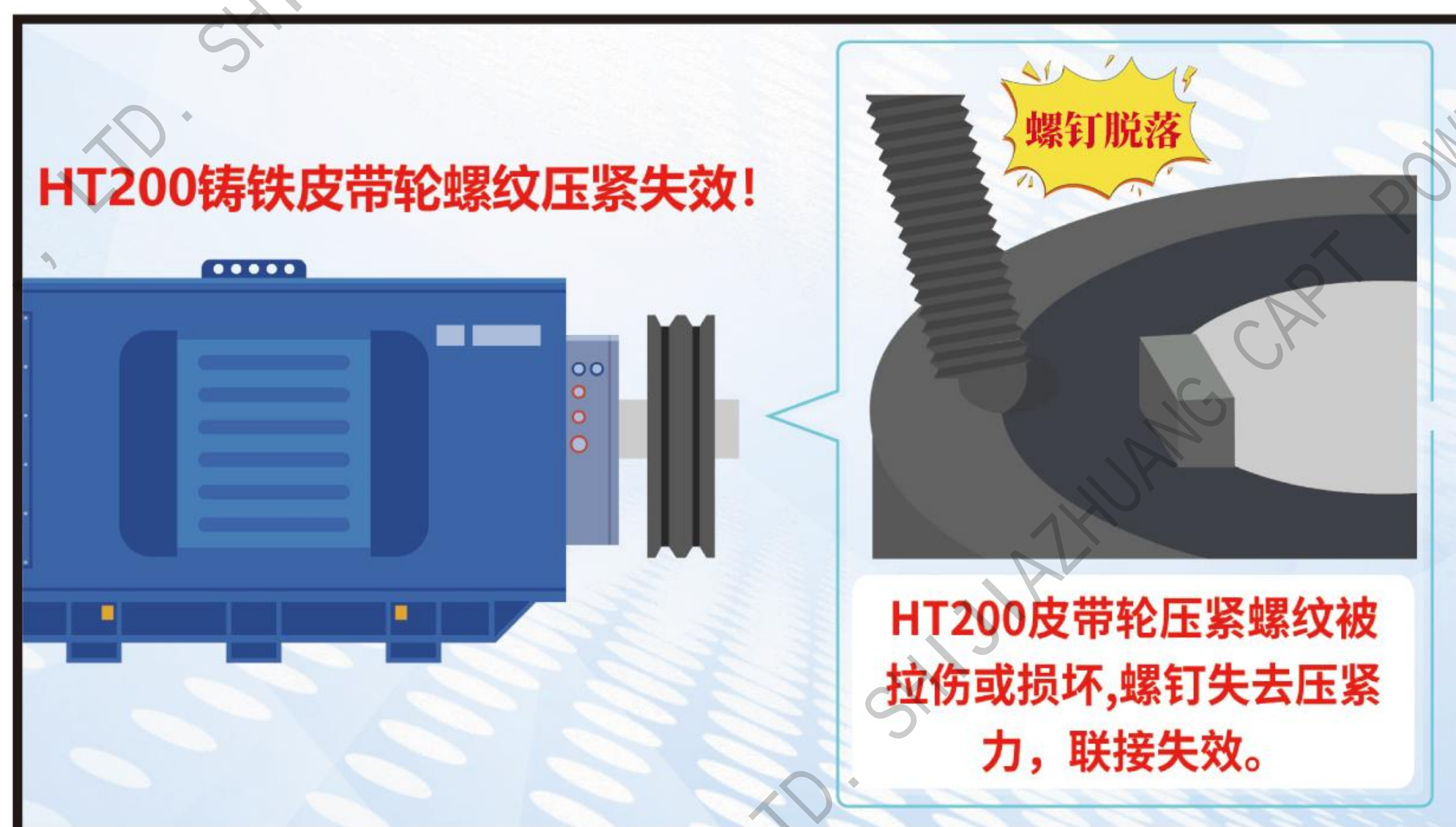
⑮螺孔“滑扣”造成压紧螺纹失效而分离脱出
